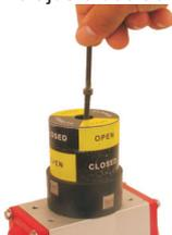
3º - Ajuste o indicador local girando-o com a mão de modo que o alvo metálico superior fique sob o sensor 1 e o alvo metálico inferior a 90º, observando o sentido em que o atuador irá girar, então aperte o parafuso de fixação do indicador local.
