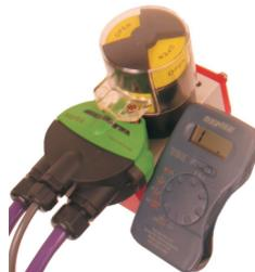
4° - Movimente a válvula para a posição fechada, o multímetro 2 na escala de resistência deverá indicar infinito.
