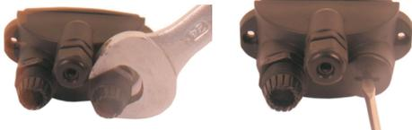
11º - Instale agora o cabo da solenóide no prensa cabos nº 3, repetindo os passos 6, 7 e 8. Caso o monitor não seja conectado a nenhuma solenóide, substitua o prensa cabos por um tampão PG 9 (cabos de 4 a 8mm), repetindo o item 10.
