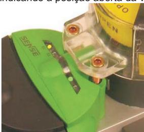
5° - Coloque a válvula na posição fechada, o led S2 deverá ascender, indicando a posição fechada da válvula.
