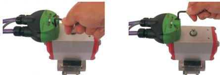
3º - monte o "copinho" sobre o atuador pneumático inserindo os distanciadores quando necessário de acordo com a altura do eixo:
