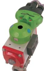
8º - verifique o funcionamento do conjunto monitor/atuador, para tanto conecte a alimentação do monitor conforme o seu diagrama de conexões, verificando o acionamento do led de alimentação.
