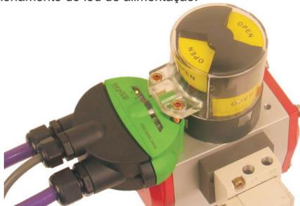
7º - Com o sensor S1 acionado, ou seja, com o alvo metálico ou magnético posicionado na frente do alvo superior do monitor, o seu respectivo led deverá acender.
