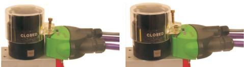
6º - Agora teste o funcionamento do conjunto monitor / atuador, para tanto conecte a alimentação do monitor conforme o seu diagrama de conexões, verificando o acionamento do led de alimentação.
