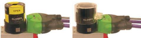
5º - Coloque os dois parafusos de fixação M5x45mm e aperte com uma chave para sextavado interno de 4mm, não exagere no aperto para não danificar o acrílico.
