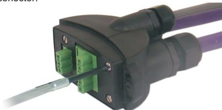
17° Aperte firmemente os prensa cabos, encaixe o monitor na caixa de conexões e aperte os dois parafusos de fixação.
