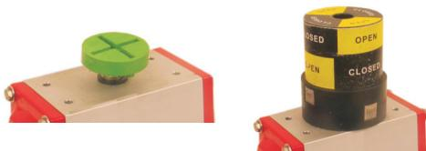
2º - Coloque o parafuso M6x 30mm para fixação do indicador local ao eixo do atuador e aperte-o com uma chave adequada mas não aperte demasiadamente afim de possibilitar o ajuste dos acionadores.
